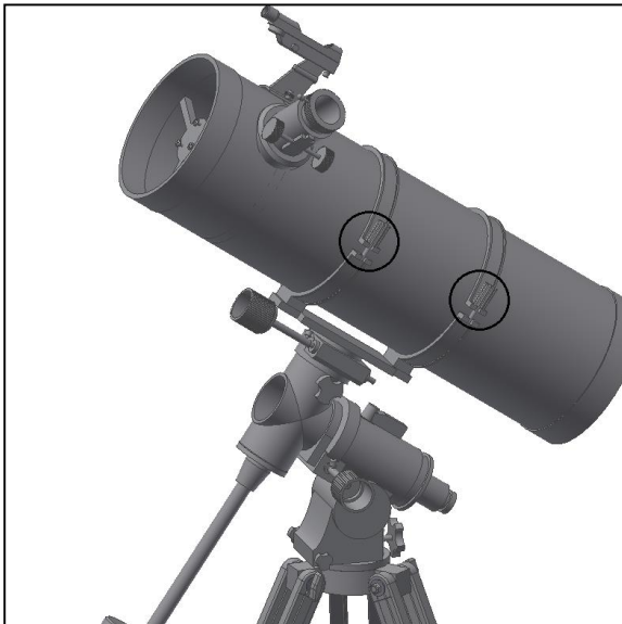
Abb. 9. Anbringung des Tubus und der Rohrschellen.
