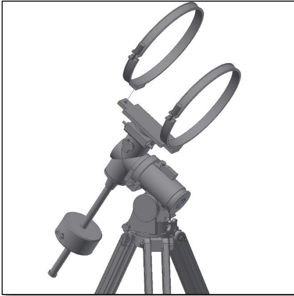
Abb. 7. Anbringung der Rohrschellen.
